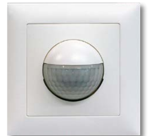
Bewegungsmelder enthalten einen PIR-Sensor (passive Infrarot) zur Erfassung der Anwesenheit von Personen. Der Belegungszustand wird mit einem potentialfreien Digitalausgang an das Regelungssystem übertragen.
