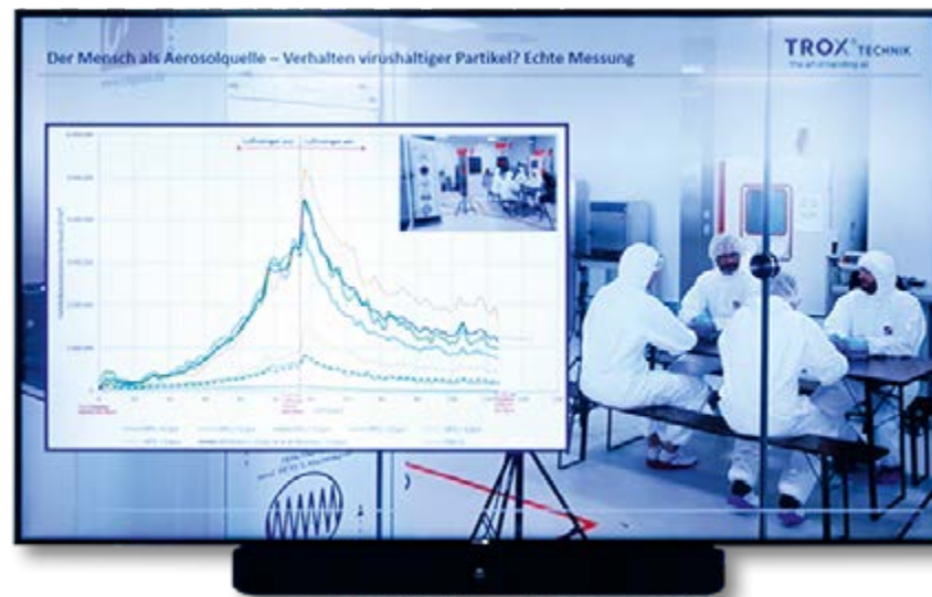
Messungen im Labor, das mit vier Personen besetzt war, zeigten, dass die Viruslast mit einem Luftreiniger deutlich reduziert werden kann.
